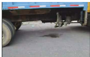
Fotografía N° 9, Lixiviados escurriendo de un transporte
