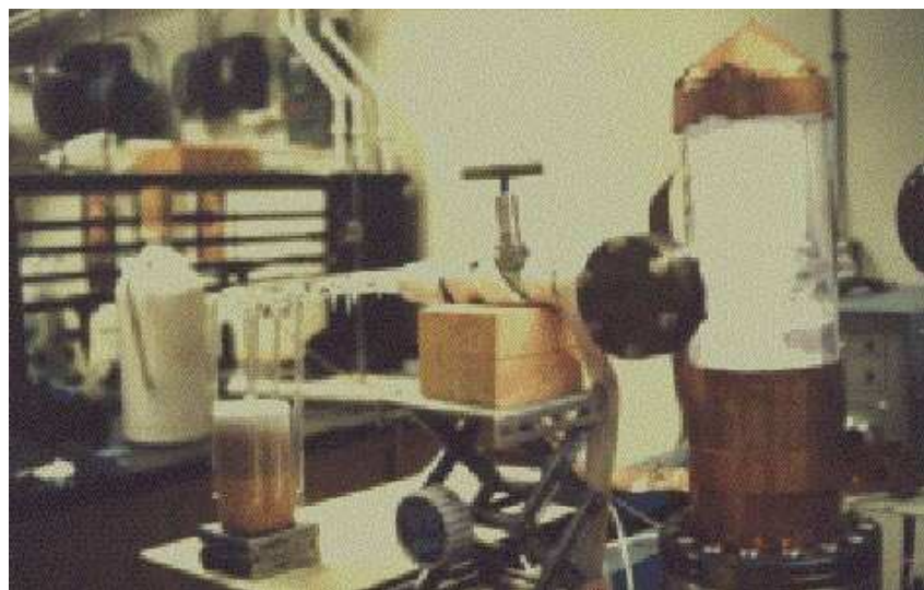
Figura 10: Sistema completo para producción de plasma químico, con el que se extrae anhídrido carbónico de la muestra arqueológica (el que permite el fechamiento), tomado de ROWE, M. y STEELMAN, K. 2007
