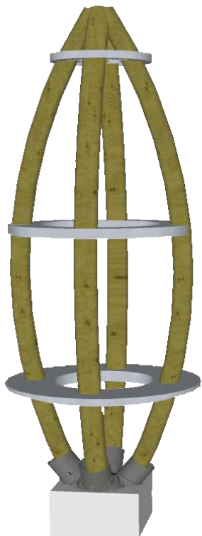
ESTRUCTURA DE MIRADORES ELABORADA CON BAMBÚ Y ANILLOS DE ACERO
