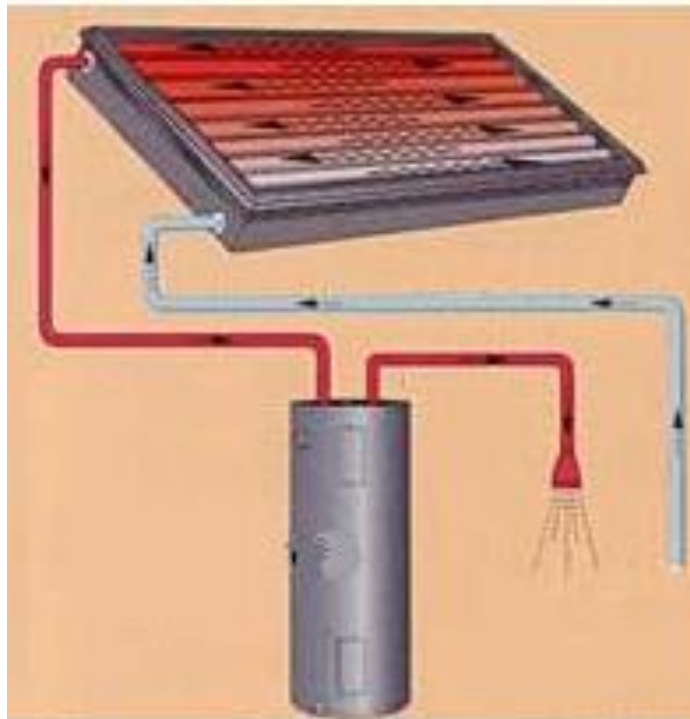
Figura No. 27 Panel Térmico
