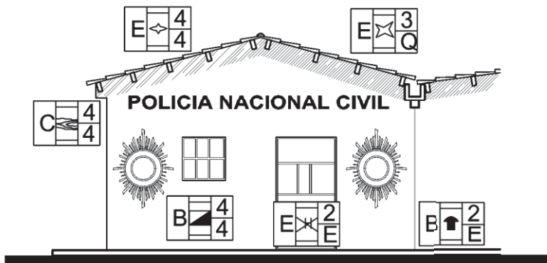
ED-5 POLICIA NACIONAL CIVIL (PNC) DAÑOS Y ALTERACIONES
