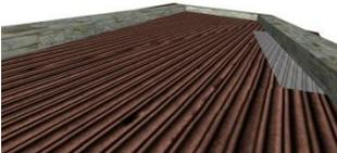
Con el fin de evitar un alto impacto en el ambiente, se reduce la posibilidad de una visual directa a la cubierta, proyectando una cenefa sobre el nivel de la estructura de metal que da cubierta al museo, creando un cerco que la protege y oculta a la visual en el exterior. Sin embargo respetando el punto anterior, en el interior se deja expuesta la estructura de la cubierta y el material.
