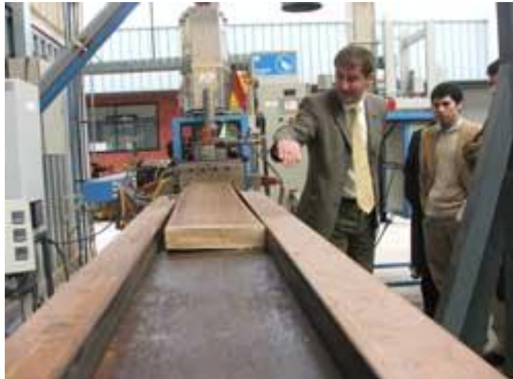
Figura 27. Fabricación de tableros moldeados por compresión y extrusión 50
