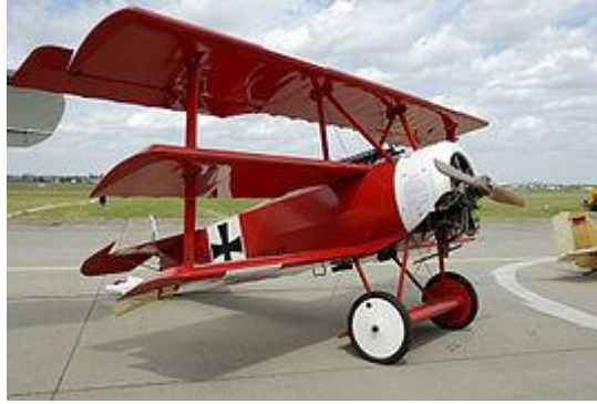
Figura 10. Fokker DR.1 (réplica) fue el avión preferido del mítico Barón Rojo. Sus tres pares de alas le proporcionan una excelente sustentación y agilidad, pero su gran resistencia aerodinámica mermaba considerablemente su velocidad. 29
