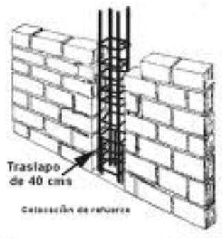
Imagen No. 82. Detalle de Levantado de muro Fuente: www.deperu.com/imagenes/cimentación
