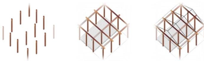
Estructura de **viviendas ampliación de crujía**. Fuente: digitalización propia, AutoCAD 2.011
