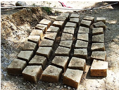
Fotografía. No.22 Producción de Adobe
