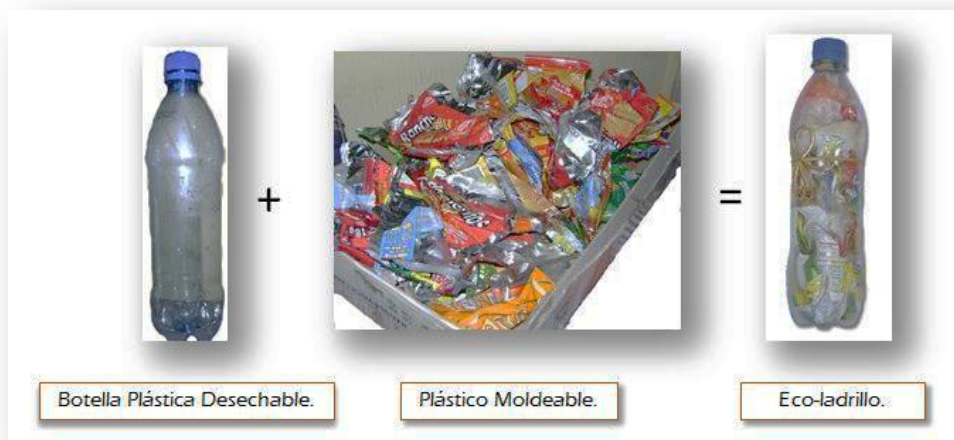
Fotografía 24 Composición de un Eco-ladrillo. Fuente: Propia.
