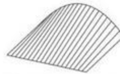
BOVEDA FORMADA POR LA UNION REGLADA DE UNA RECTA Y UN ARCO PARABOLICO
