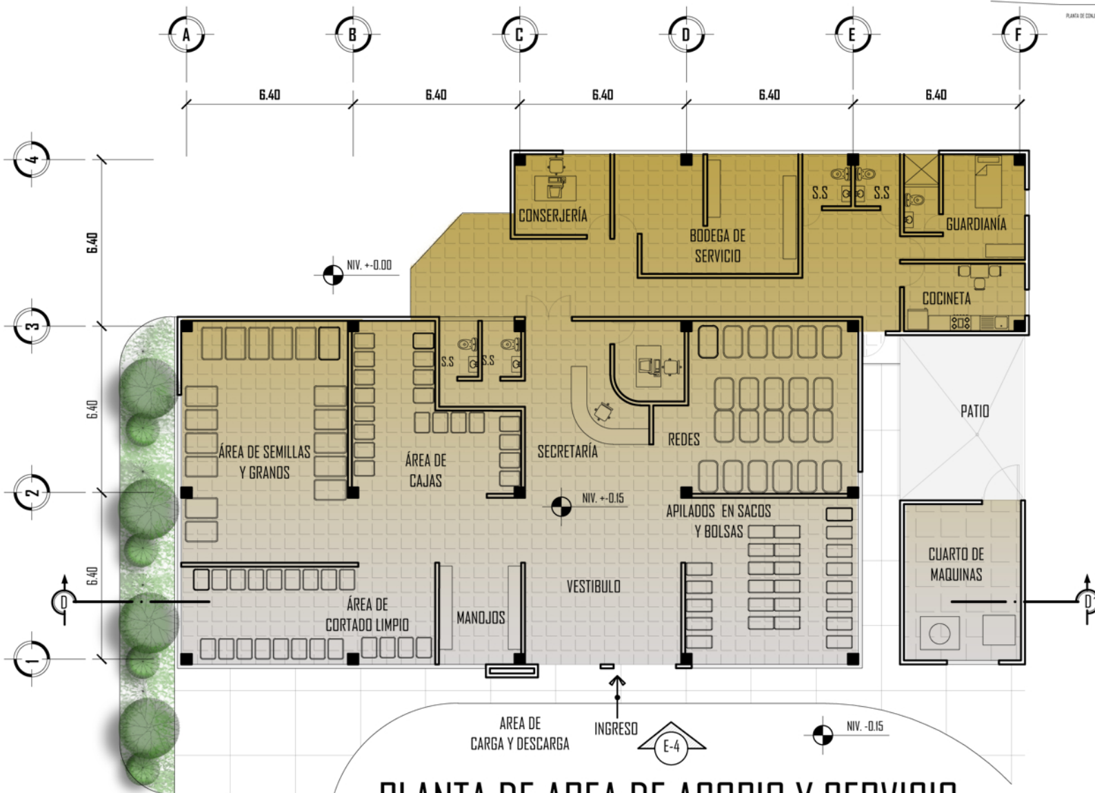
PLANTA DE AREA DE ACOPIO Y SERVICIO
