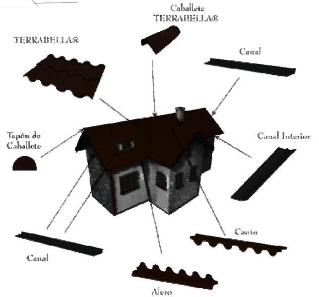
Gráfica 3 lamina a utilizar, simulación de teja.
