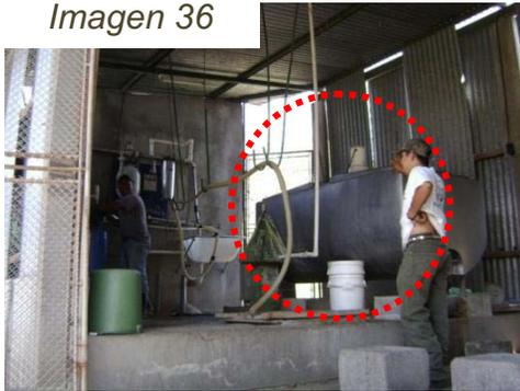
El cuarto de almacenamiento de leche posee tanques de acero inoxidable (milk keeper) que contienen la leche a una temperatura fría por medio de refrigeradores eléctricos para alargar su duración. Este cuarto se eleva un 1. 20m del suelo para facilitar la descarga de leche en los camiones transportadores y por el uso de drenajes ubicados al suelo del lugar.
