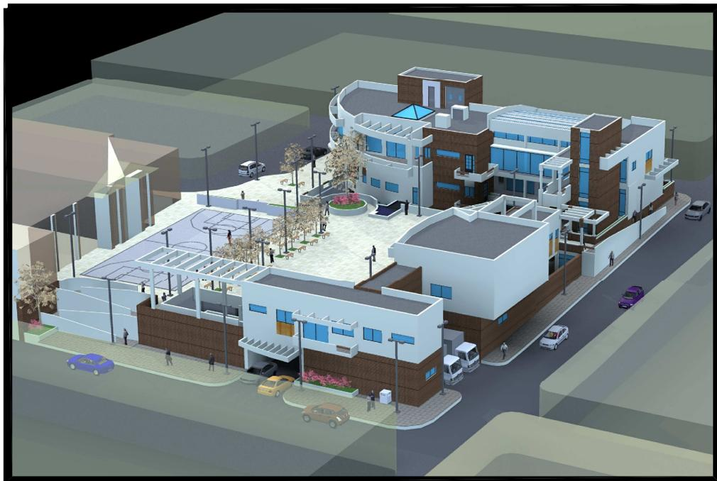
PERSPECTIVA 4: Nuevo acceso vehicular al sótano de estacionamiento, rampas de acceso peatonal y parte posterior del escenario. El bloque sobre el acceso al sótano de estacionamiento, es la nueva área de vestidores.
