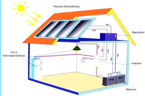
A) sistema aislado de la red eléctrica
