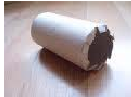
Pegado de piezas circulares, observese los cortes realizados para dar paso a la curva.
