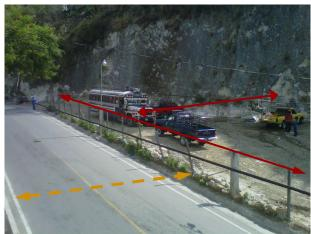
**Fotografías 21 y 22.** Ingreso principal al casco urbano, ubicado en la parte sur-este. Se improvisa un espacio para buses extraurbanos con dimensiones inadecuadas y alineación inmediata a la cinta asfáltica que puede resultar peligrosa.
