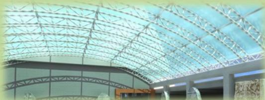
**CUBIERTA:** El techo de lámina policarbonatada y termoacústica producirá poco peso sobre las armaduras horizontales. En las losas intermedias se utilizará losacero para aligerar las cargas.
