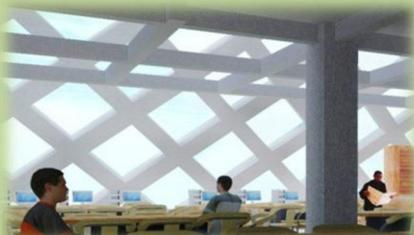
**PROTECCIONES SOLARES:** Se utilizarán protecciones solares artificiales (parteluces, cenefas, cornizas), con el fin de proveer sombra en espacios donde sea muy difícil la protección solar por medios naturales.
