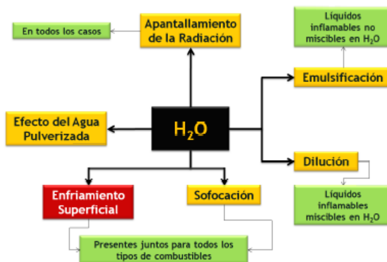
Ilustración 176, mecanismos de supresión de incendio mediante los cuales opera un sistema de supresión por agua. Fuente: red proteger, autor: Ing. Néstor Adolfo Botta
