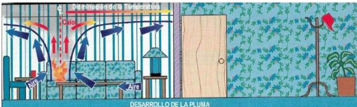
Ilustración 21, desarrollo de llama inicial en condiciones de Flashover
