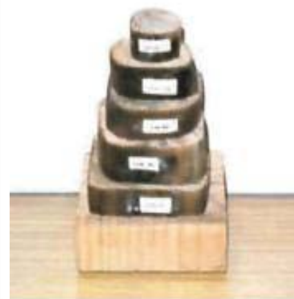
Ilustración 113, sección residual de una viga de madera expuesta diferentes rangos de tiempo
