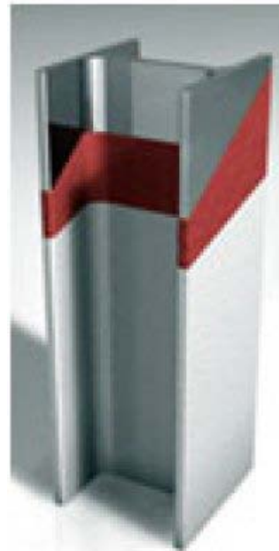
Ilustración 264, protección pasiva por pintura intumescente
