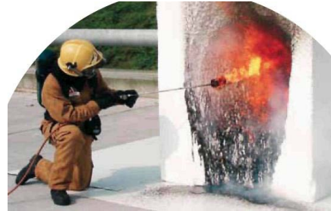
Ilustración 128, ensayo de combustión, generación y opacidad de humo en Poliestireno expandido
