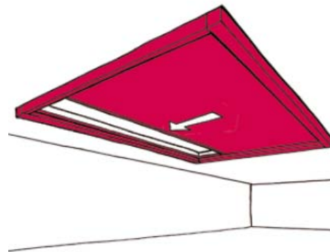
Ilustración 366, cortina de posición horizontal para dobles alturas
