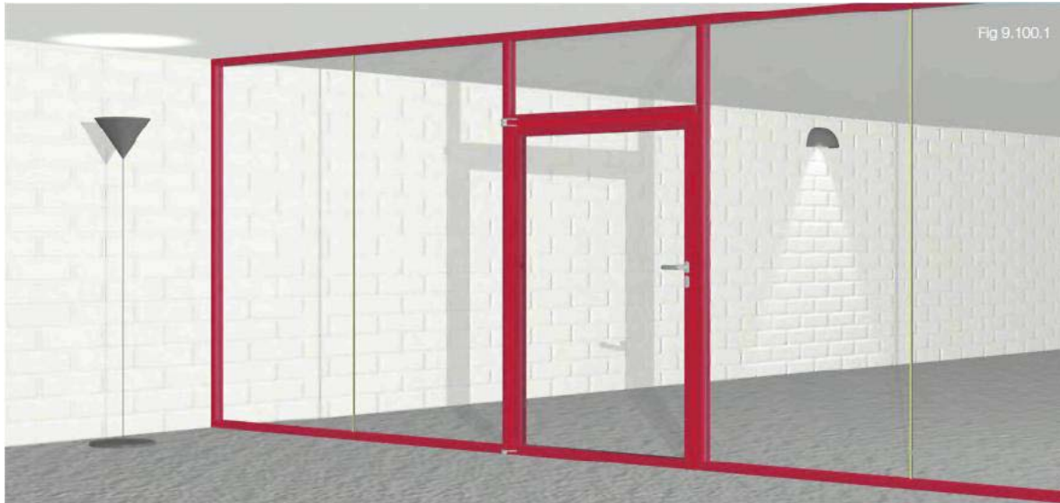
Ilustración 333, sectorización interior por medio de muros acristalados con vidrio resistente al fuego
