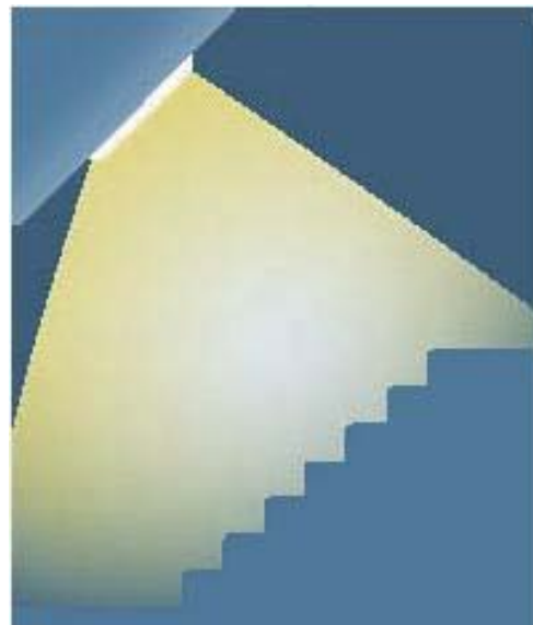
Ilustración 411, Colocación de lámparas focales en gradas de emergencia
