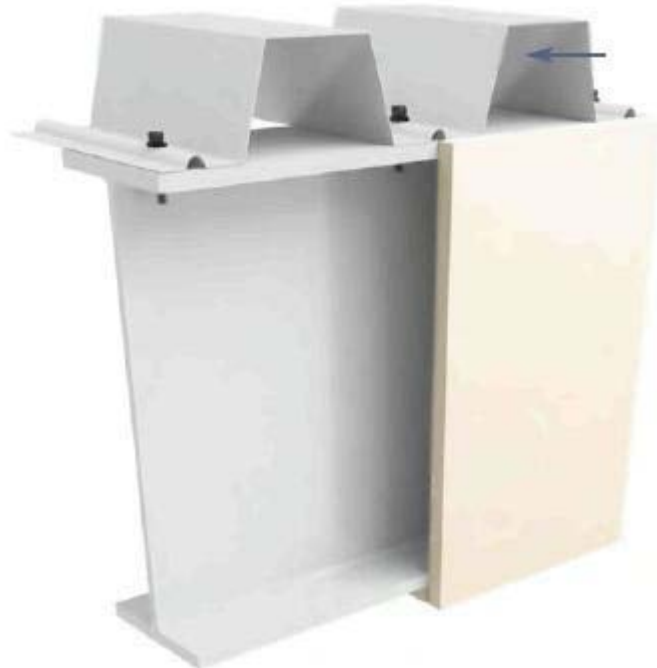
Ilustración 275, viga tipo WF como apoyo de losacero
