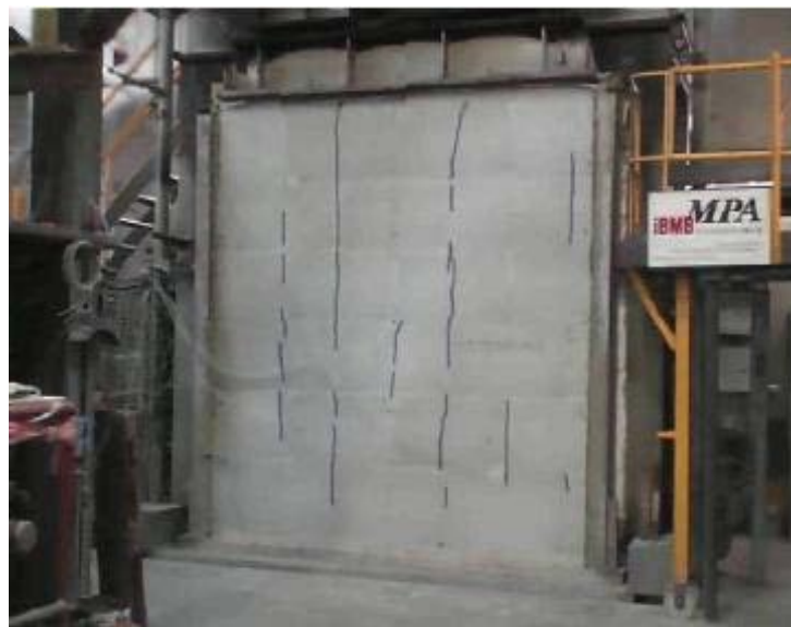
Ilustración 94, ensayo de temperatura en muro de mampostería de concreto
