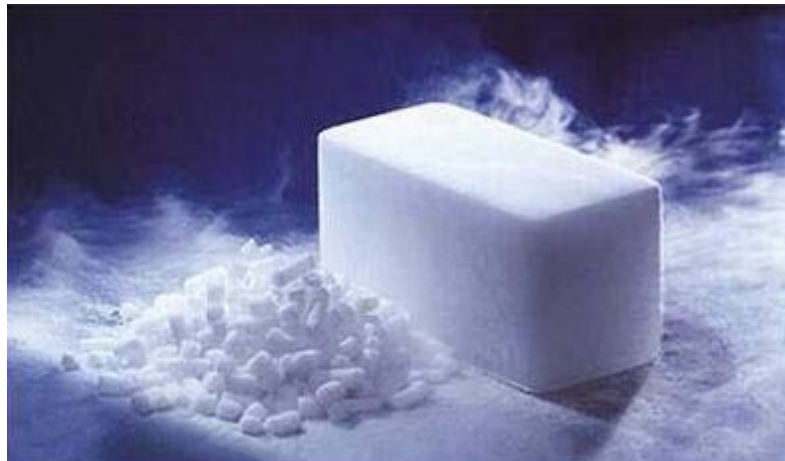
Ilustración 222, Hielo Seco, apariencia sólida del dióxido de carbono a -78°C
