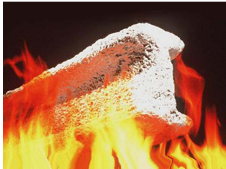
Ilustración 278, Perfil de acero WF con recubrimiento intumescente
