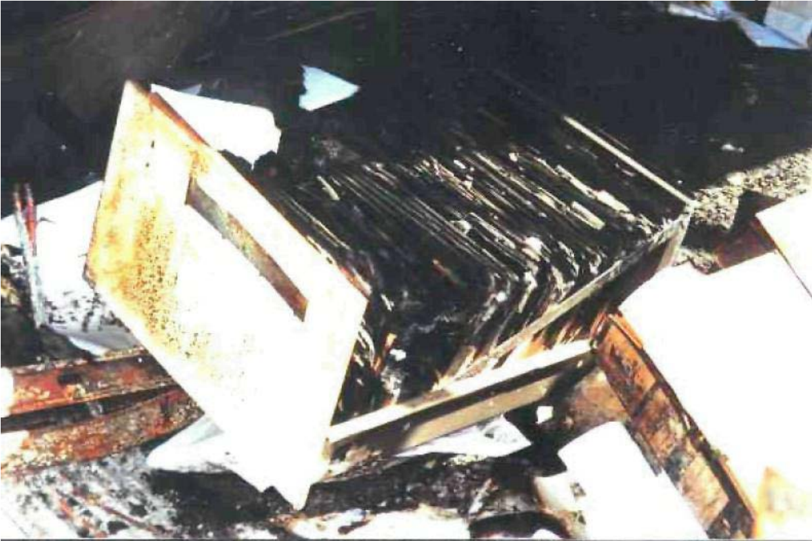
Ilustración 141, partes de un archivo de metal conteniendo papel, que aun no ha sido consumido en su totalidad, aun siendo expuesto a fuego controlado, en un ensayo normado
