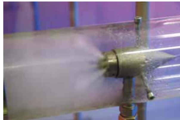
Ilustración 181, ensayo de sistema de agua nebulizada en alta presión
