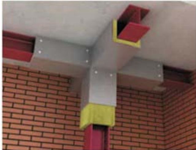
Ilustración 268, encajulado con paneles y fibra de vidrio
