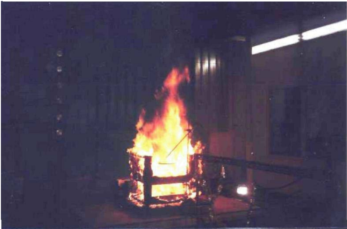
Ilustración 143, ensayo de combustión, tiempo de duración aproximadamente 3 minutos
