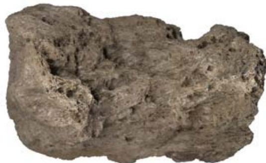
Ilustración 92, agregado tipo pómez, para blocks de concreto
