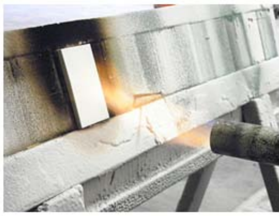
Ilustración 262, Pruebas de aplicación de llama a revestimiento ignifugante aplicado a estructuras de acero
