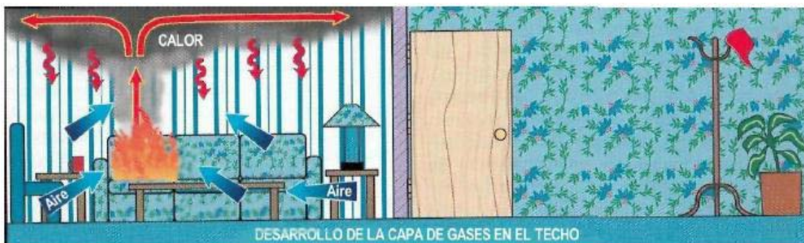
Ilustración 22 desarrollo de capa de gases de combustión
