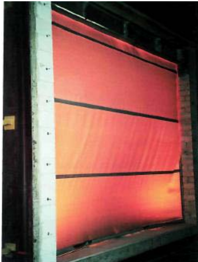
Ilustración 363, cortina resistente al fuego, durante ensayo normado de resistencia ASTM E119
