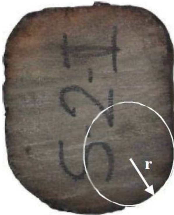
Ilustración 112, redondeo de aristas en una sección rectangular de madera
