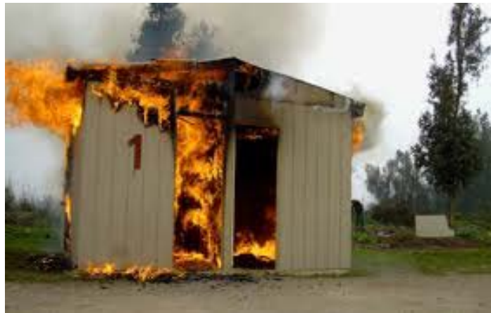
Ilustración 131, Humo de combustión de EPS en ensayo
