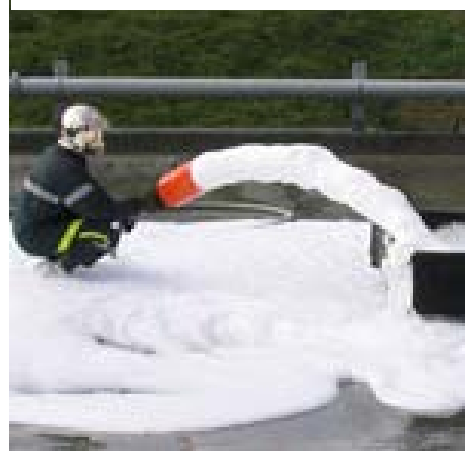
Ilustración 220, lanza portátil generadora de espuma
