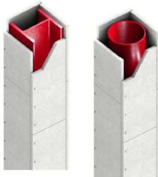
Ilustración 297, Revestimiento de acero estructural con paneles a prueba de fuego
