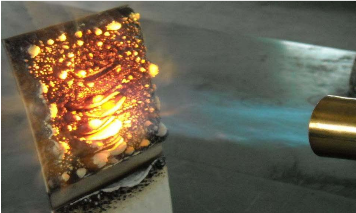
Ilustración 279, prueba de aplicación de llama directa a una superficie tratada con revestimiento intumescente
