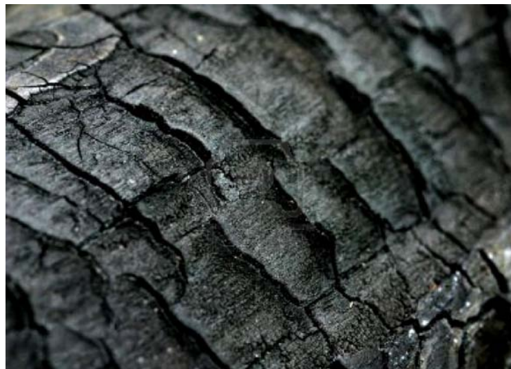
Ilustración 106, formación de beta de carbono en madera quemada
