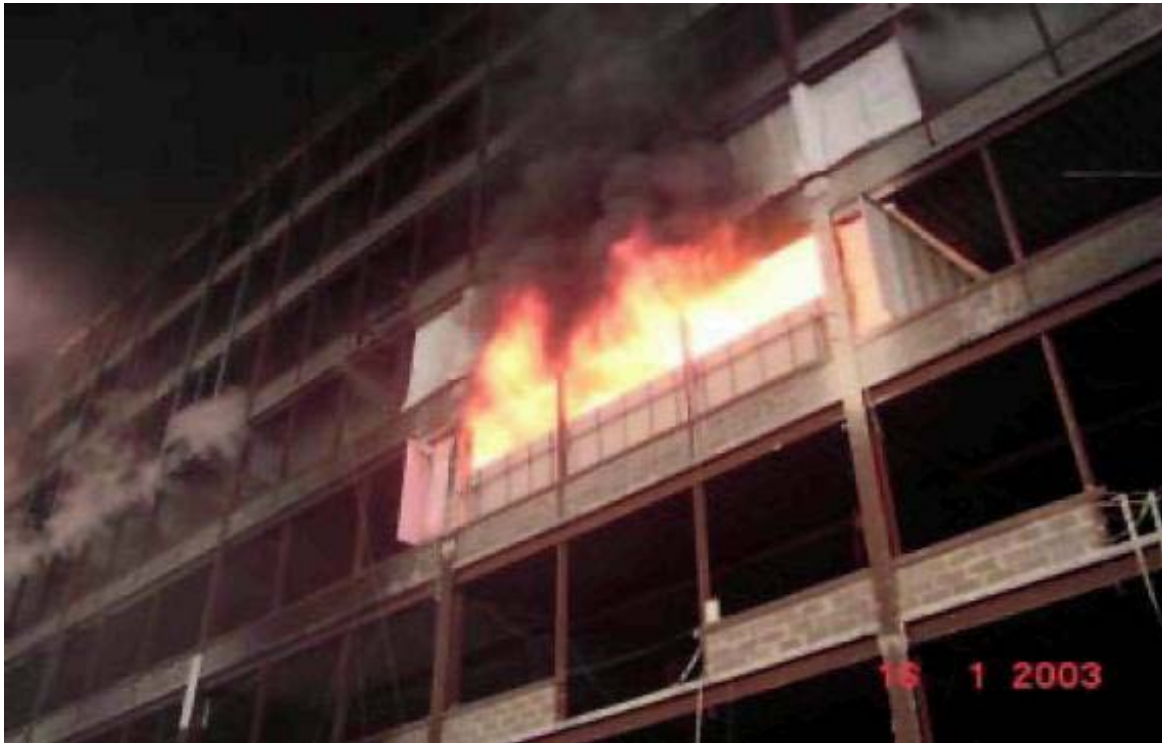
Ilustración 329, ensayo de compartimentación de sector de incendio, llevado a cabo en Inglaterra, por Building Research Establishment
