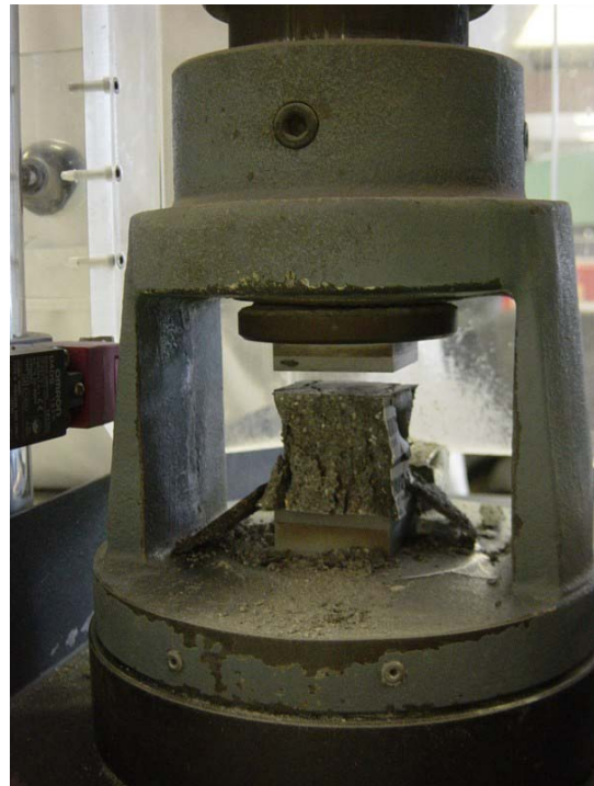
Ilustración 41, ensayo de compresión al concreto
