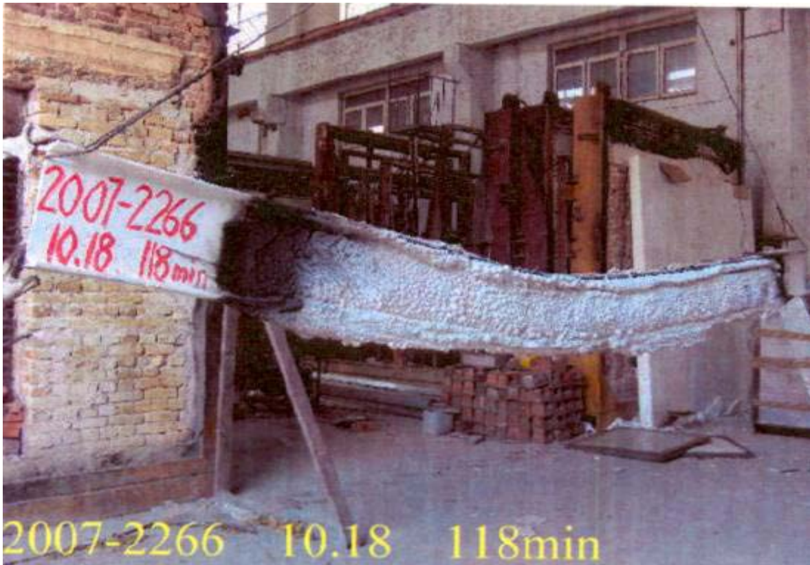
Ilustración 283, aplicación de carga de fuego a viga perfil WF, durante 118 minutos, condiciones de fuego y de carga constantes
