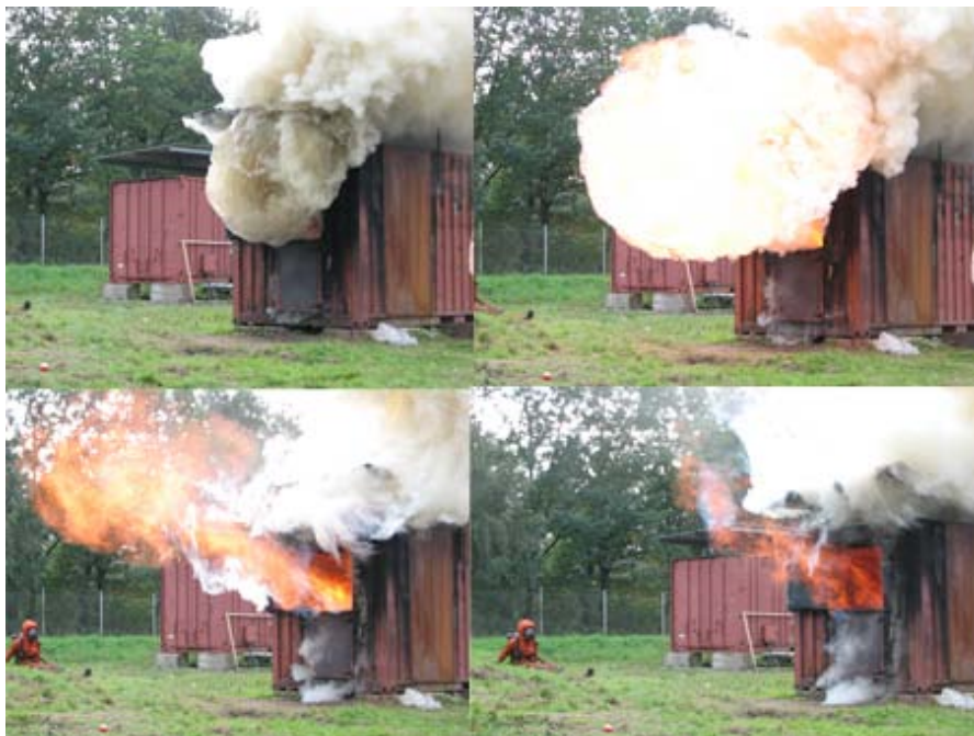
Ilustración 29, manifestaciones comunes del fenómeno Backdraft (imágenes superiores), y del fenómeno Flashover (imágenes inferiores)
