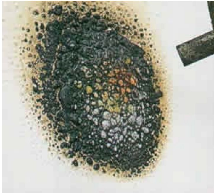
Ilustración 277, aplicación de llama directa sobre superficie con tratamiento intumescente
