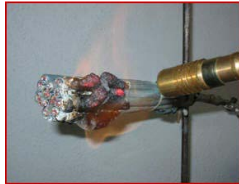
Ilustración 153, ensayo de fuego a cables con revestimiento ignifugo
