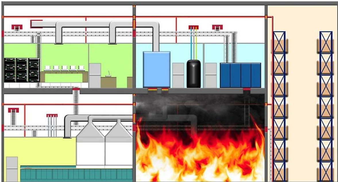
Ilustración 325, Ejemplo de compartimentación en sectores de incendio
