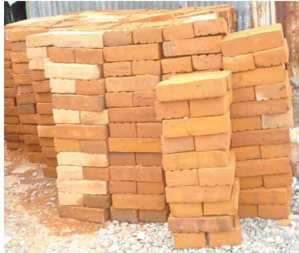
Ilustración 317, piezas de ladrillo refractario de arcilla
