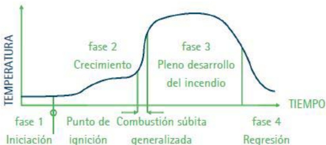
Ilustración 8, fases del desarrollo de un incendio
