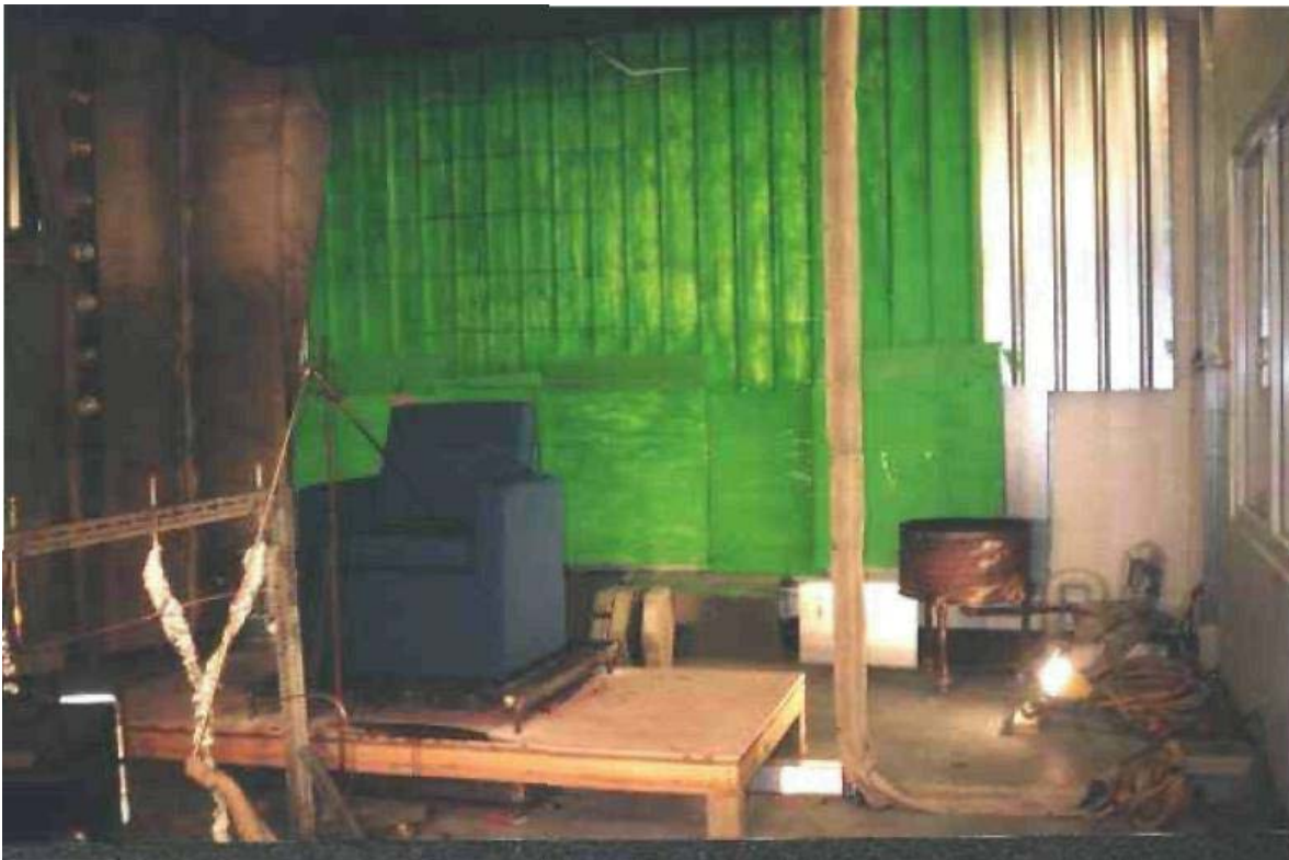
Ilustración 142, ensayo de combustión realizado con un mueble tapizado, para determinar el tiempo en que el material es totalmente consumido
