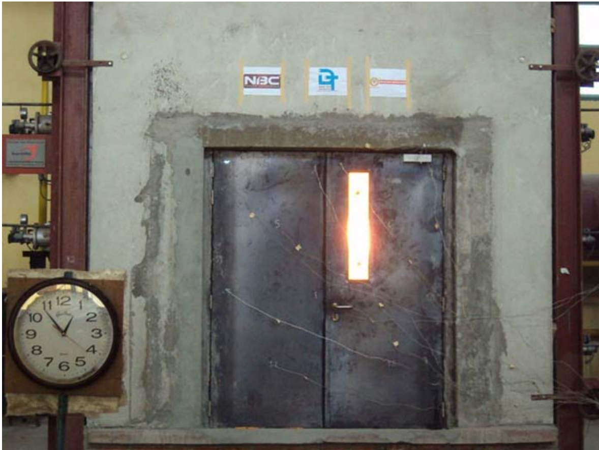
Ilustración 408, las puertas a prueba de fuego son elementos que han sido ensayados bajo diferentes normativas para garantizar su resistencia al fuego, su capacidad portante, su integridad y su estanqueidad ante humo
