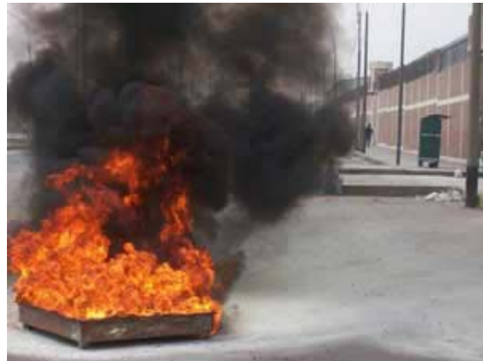
Ilustración 129, combustión de pieza de Poliestireno expandido al aire libre, nótese la cantidad de humo que se genera en condiciones de combustión con llama
