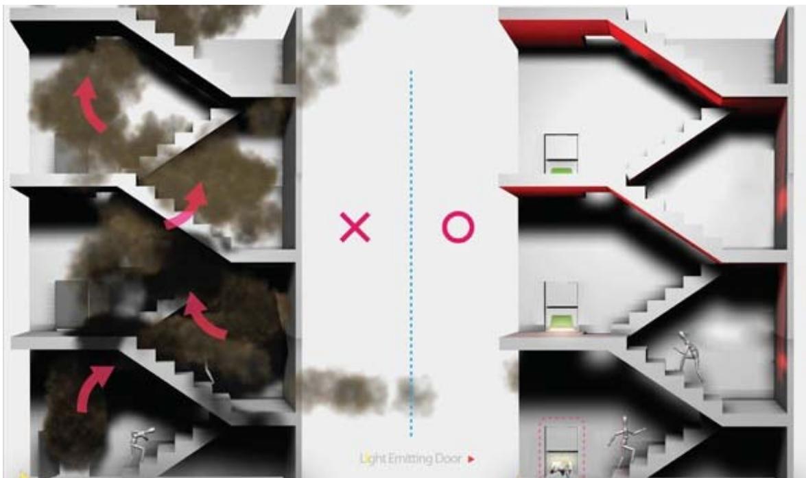
Ilustración 327, las rutas de evacuación deben de ser seguras y estar disponibles en todo momento, libres de contaminación y blindadas al efecto del fuego y de las altas temperaturas
