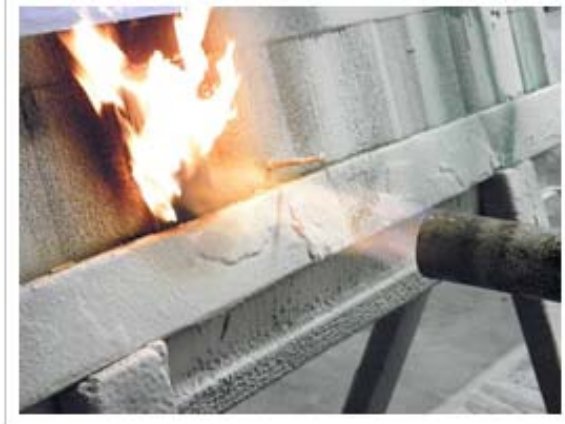
Ilustración 262, Pruebas de aplicación de llama a revestimiento ignifugante aplicado a estructuras de acero
