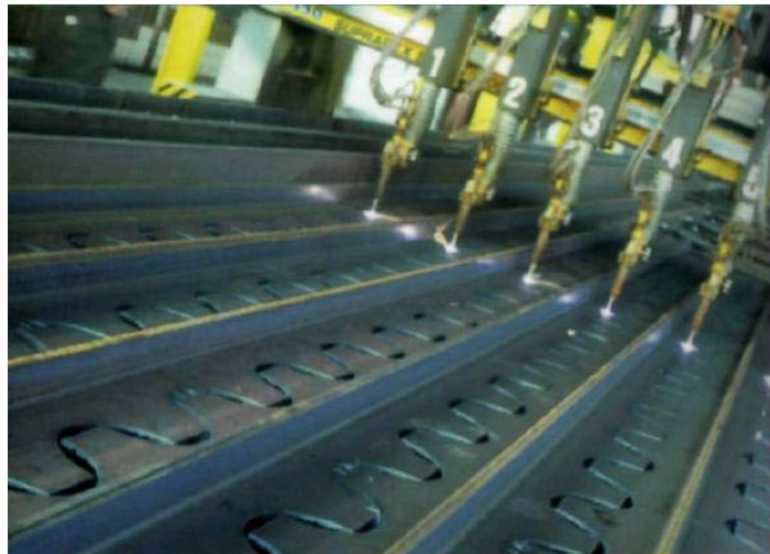
Ilustración 79, proceso de corte de alma de vigas WF en fabrica
