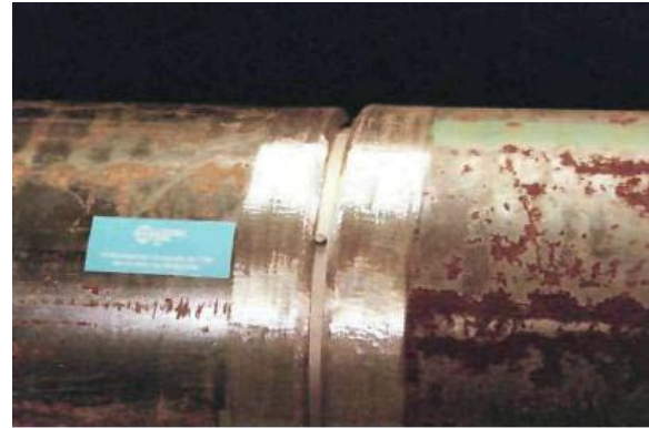
Ilustración 244, uniones de tubería con anillo de soporte
