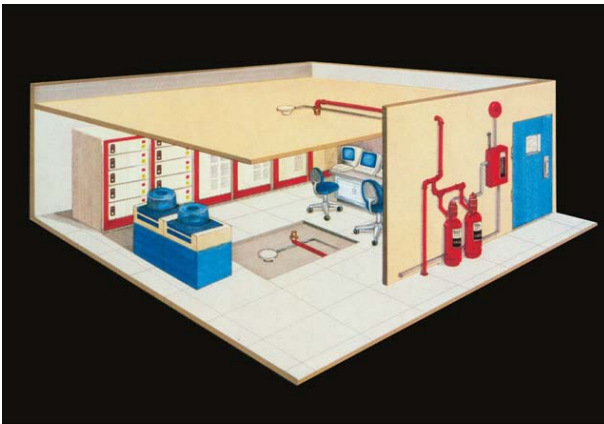
Ilustración 253, cuando no es posible una descarga local debido a fugas, se debe de proteger todos los ambientes circundantes para garantizar la protección y la concentración de diseño requerida
