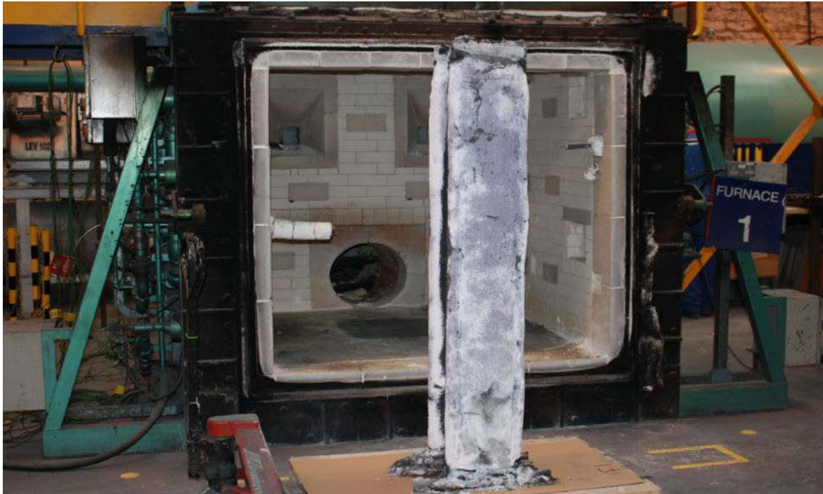
Ilustración 284, ensayo de fuego a perfil WF con recubrimiento intumescente bajo parámetros normados por ASTM E119
