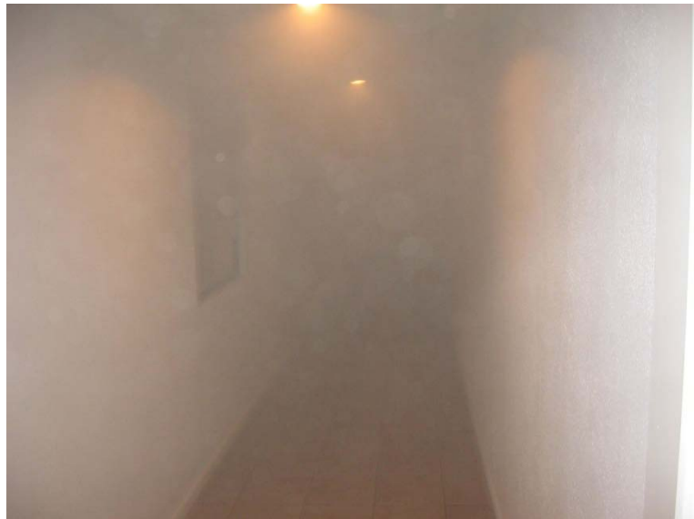
Ilustración 351, el humo contenido y estancado en pasillos hace imposible la visión de las rutas de evacuación
