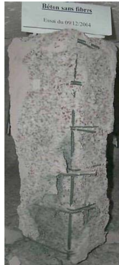
Ilustración 49, daños en un prisma de concreto ensayado al fuego
