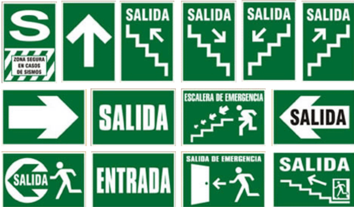
Ilustración 167, señales lumínicas de evacuación, estandarizadas internacionalmente. Fuente: Norma ISO 3864
