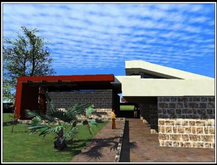
APUNTE NORTE. UTILIZACIÓN DE COLORES QUE IDENTIFIQUEN EL EDIFICIO, UTILIZACIÓN DE MATERIALES DE LA REGIÓN COMO; MADERA Y TEJA EN LOS TECHOS INCLINADOS Y PISO DE BARRO O RÚSTICO Y MUROS DE PIEDRA.
