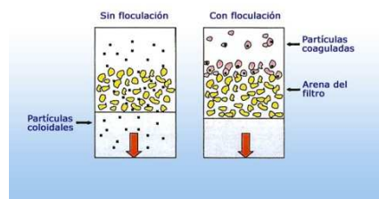
Imagen de principio de floculación Fuente: http:// www.assurpiscinas.com
