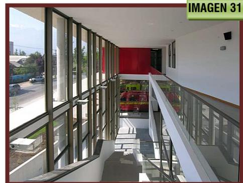
Constructivamente el edificio es de hormigón armado con dióxido de titanio y un sistema de moldajes, los cuales han sido diseñados y modulados a partir de la geometría de vanos, vigas, antepechos, ante techos y muros. A la manera de un fauve en el piso superior, aparece un elemento de fachada rojo (Alucobond), que destaca por sobre la uniformidad de la materialidad<sup>37</sup>.
