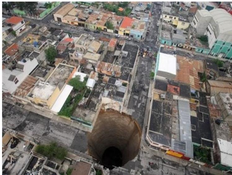
**Ilustración 6. agujero de la zona 6, producto de la erosión del subsuelo, por daño en los drenajes. 2008 creando una licuefacción considerado como un desastre antrópico**
