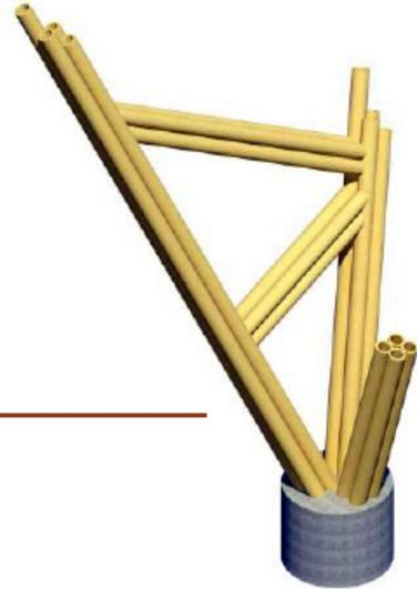
**DETALLE 2** propuesta de anclajes estructurales a base de rigidizar diagonalmente y utilizar tornillos de rosca sin fin.
