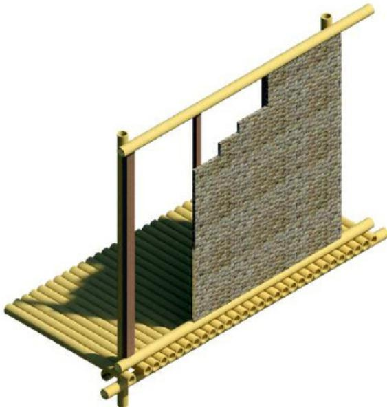
**DETALLE 1** propuesta de cimentación a base de pilotes de concreto y anclajes metálicos que sirven de soporte para las cañas de bambú. Rigidizantes de bambú a razón de 4 varas en sentido diagonal.
