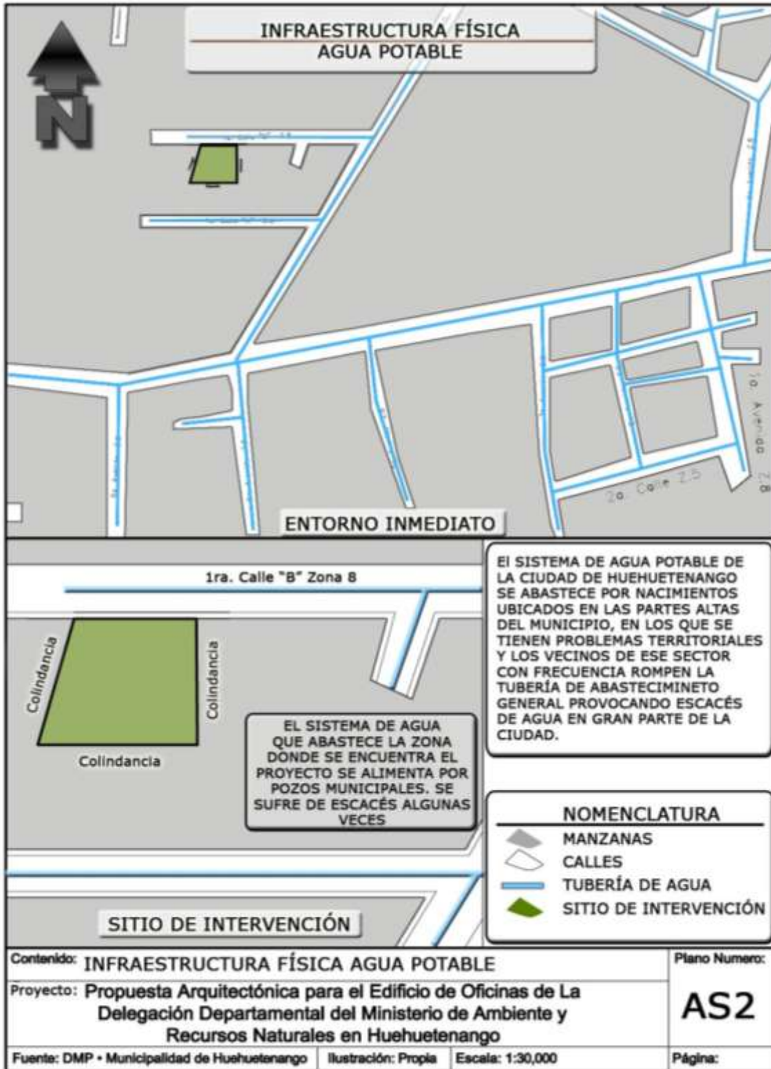
Plano 2 AS2 Infraestructura Física, Agua potable
