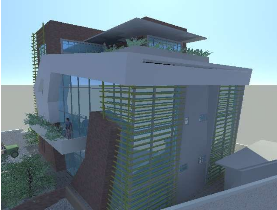
Fotografía 29 Apunte, pantalla de bambú en fachada oeste
