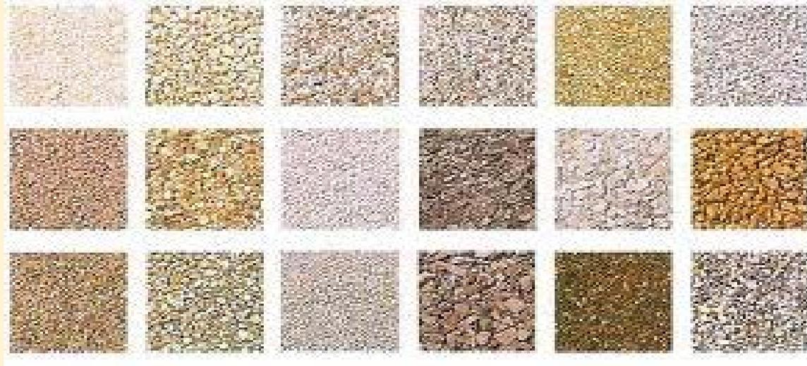
Se entiende como árido a los materiales granulares inertes que no reaccionarán con el cemento y los agentes medioambientales. Son de naturaleza inorgánica. Encontrándose en abundancia en los bancos de canteras de las montañas del municipio.
