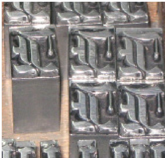
Figura 18. Tipos móviles, Editorial Universitaria. Utilizados en la impresión de Títulos, diplomas, etc.
