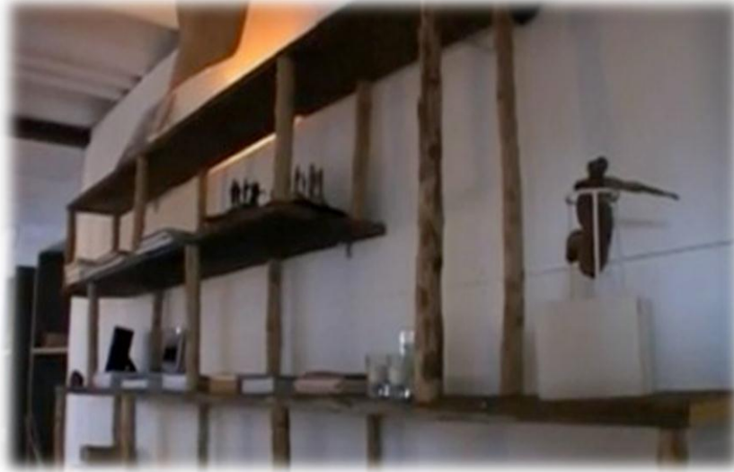
Fotografía No. 10: Librería fabricada con ramas de café, esta madera se obtiene al podar la planta del café, también se utiliza para las estufas en el área rural. Fuente: Documental de TV. Tecnología Verde.
