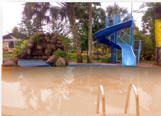
Foto No. No.205 vista agua con oxidación reaccio de mineral al cloro Oscar López
