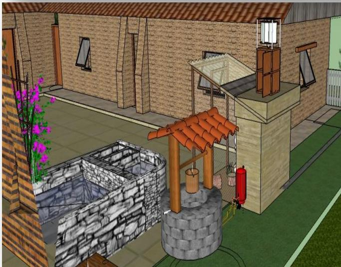
EL AGUA POTABLE SE OBTENDRA POR MEDIO DEL BOMBEO DE UN POZO ARTESANAL, UTILIZANDO ENERGIA EOLICA PARA EL FUNCIONAMIENTO DE LA BOMBA, HACIA UN CISTERNA ELEVADO PARA QUE TENGA CAIDA LIBRE EN LA REGADERA, LAVAMANOS Y PILA.
