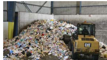
Foto no2. Maquina recolectando la basura para enviarla a la empacadora y faja separadora de materiales.
