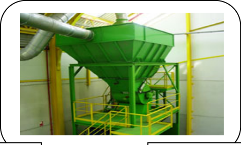
Foto no. 6 al ser separada la basura pasa por una maquina prensadora, para ser trasladada a otro destino o planta, o simplemente para ser puesta en otro sector de la planta para ser reutilizado en otra maquina
