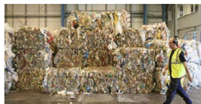
Foto no. 3 vemos ya la basura en forma de cubos lista para ser enviada a otras partes de la planta para un proceso posterior, o enviarlas a otras plantas especializadas en otras materias
