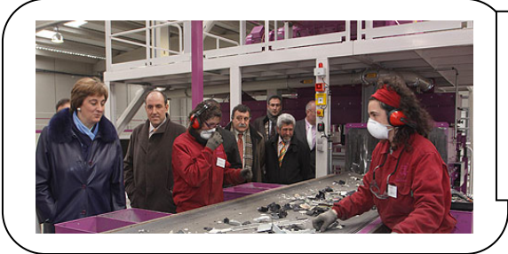
Foto no. 4 donde se puede observar que la basura después de ser llevada pasa por un proceso de separación dependiendo el material que sea, así su destino lo indican las personas que trabajan en esta faja por donde pasan los desechos. Fotografía extraída del diario el mundo.es, del artículo de plantas recicladoras.
