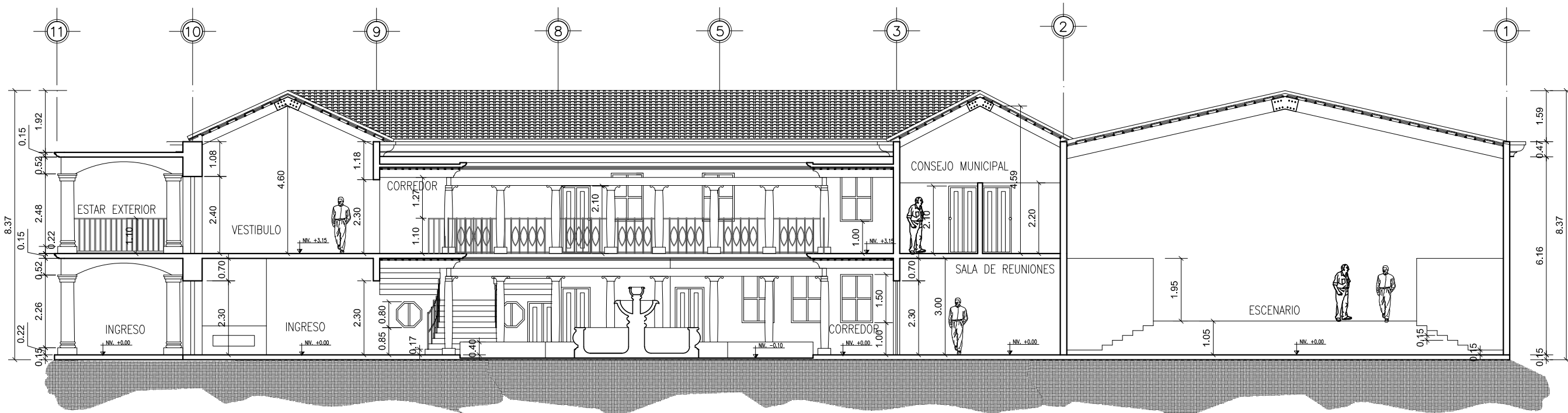
SECCION B-B EDIFICIO MUNICIPAL
