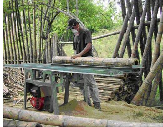
**Fotografía No. 13 Máquinas para obtener Fotografía No. 14 Sacando esterilla reglillas de bambú**
