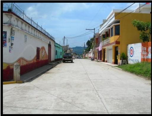
FOTO 12: Vivienda de Adobe izquierda con techo de madera y cubierta de lámina, Y a la derecha de Dos niveles.
