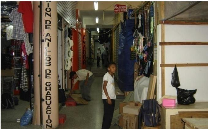
Pasillos de 2.50 metros, cerramientos de block para los locales, uso marcos estructurales de concreto armado.
