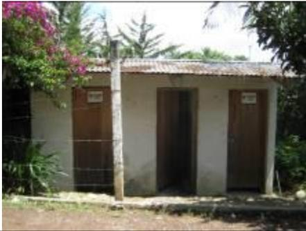
Fotografía No. 6 Módulo de servicios sanitarios del Calvario el cual cuenta con levantado de block + cubierta de lámina de zinc y acabados con puertas de madera.
