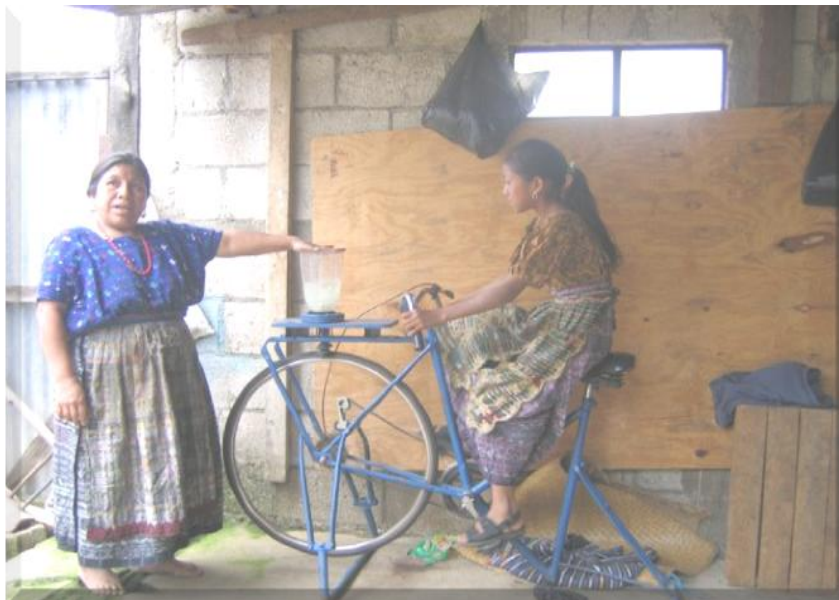
Licuadora, con mecanismo de poleas de una bicicleta
