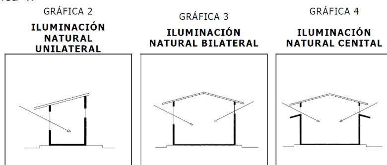
GRÁFICA 2,3,4. Normativos para el diseño arquitectónico de centros educativos oficiales, redigo por el Ministerio de Educación
