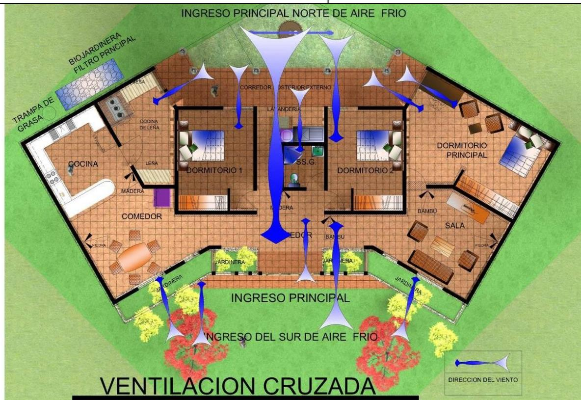
Grandes cantidades de aire ingresa por el norte y atraviesa la toda la vivienda, las brisas del sur también se hacen notar, el aire caliente es expulsado al exterior, el flujo de aire se mantiene en constante movimiento impidiendo el calentamiento de los ambientes. El aire es extraído al exterior por medio del efecto de chimenea en la vivienda
