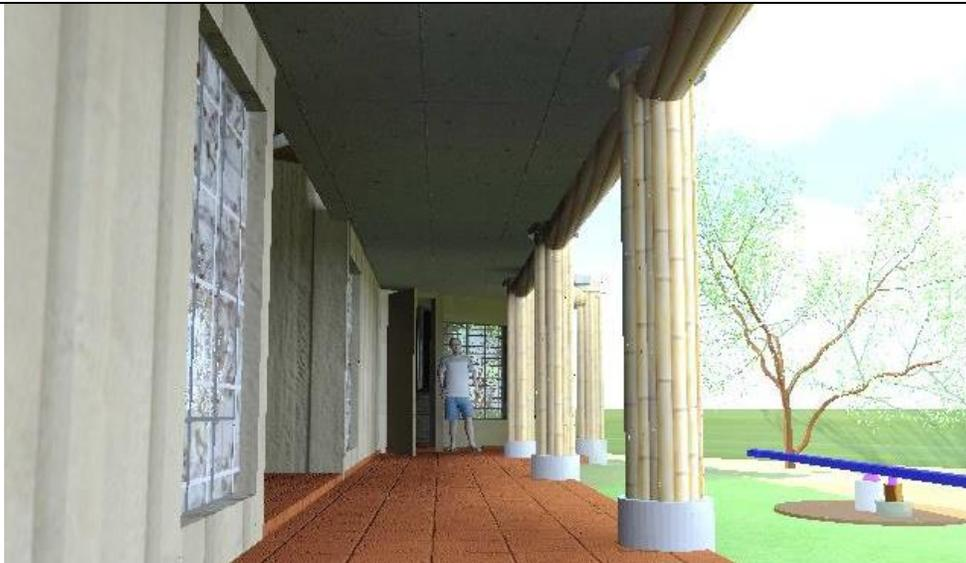
Parales interiores en el corredor y ventanas tejidas con material de bambú cortado que permitan el ingreso de aire frío estas tendrán que ser completamente abatibles.
