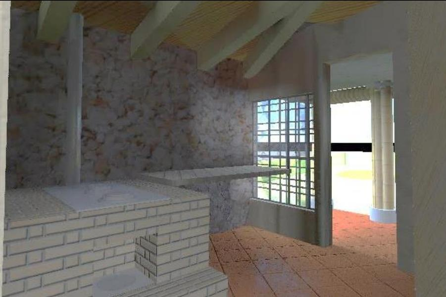
Es una estufa de leña que su mejora esta en que puede almacenar en su sistema por mas tiempo el calor que ejerce la leña al consumirse el fuego y lograr cocinar con el calor y no con la llama. Sus materiales pueden ser reciclados pues la plancha puede ser del material de un tonel usado.
