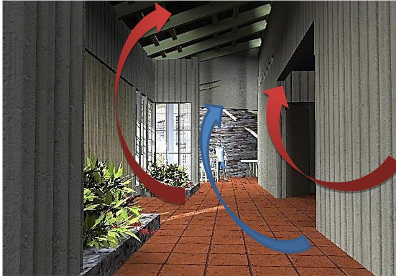
El Aire cruzado ingresa a la vivienda y cruza, cabe destacar que los espacios abiertos en el techo hacen que por convección del aire, el aire caliente salga por las partes altas evitando el almacenamiento en el interior de la vivienda evitando la elevación de la temperatura. Incluye un área verde en el interior.
