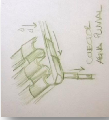
DETALLES COLECTORES DE AGUA
