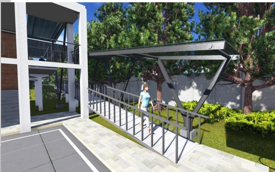
*Para la cubierta de la rampa Peatonal se propone la utilización de una estructura metálica + una cubierta de coroplast.*
