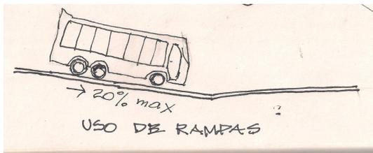
Proponemos el diseño de una rampa que tendrá una inclinación máxima del 18 o 20% y descendera aproximadamente 3.00 mts
