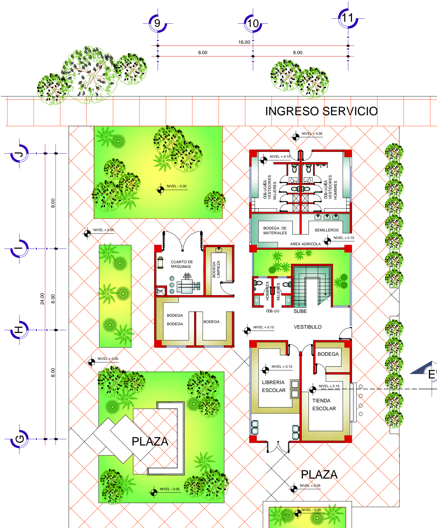
PLANTA AREA SERVICIO 1er. Nivel INSTITUTO NACIONAL DE EDUCACIÓN BÁSICA (I.N.E.B.), ALDEA CAJOLÁ CHIQUITO, MUNICIPIO DE CAJOLÁ QUETZALTENANGO ESC : 1:200
