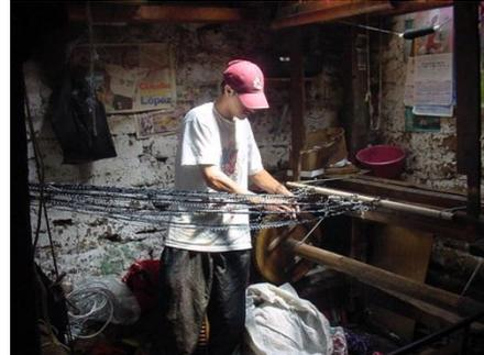
**Henchido de un hilo de color:** Consiste en enrollar el hilo en una madeja a una canilla ya sea de hilo color o labores en jaspes de trama cuando forma de un cono de hilera.
