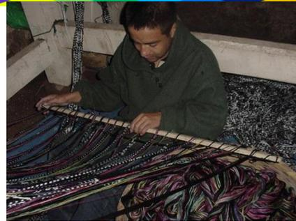
**Avetillado de una tela:** Este es un proceso que se realiza para unir las hebras de hilo de la tela que se terminó con las hebras de hilo de una tela nueva por medio de un nudo llamado beta, que consiste en darle una pequeña torsión en los extremos de los hilos entrecruzándolos, utilizando para ello los dedos pulgares e índices de ambas manos. <sup>36</sup>
