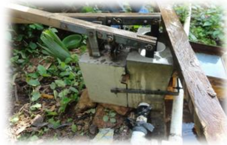
INFORMACIÓN DE CAMPO: Bomba de pedaleo PET y sistema de manejo/vivienda sostenible/ Caserío el Conacaste/Chanrrayo/ San Agustín Acasaguastlán/El Progreso. FOTO 6 : Cotóm, C.
