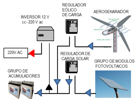
DIAGRAMA 4 – Eléctrico Solar-Eólico FUENTE : La Casa Ecológica Autosuficiente (clima cálido y tropical) pág 55 – Armando Caffis Caso - 1994 Elaboración adaptada: Cotóm, C.
