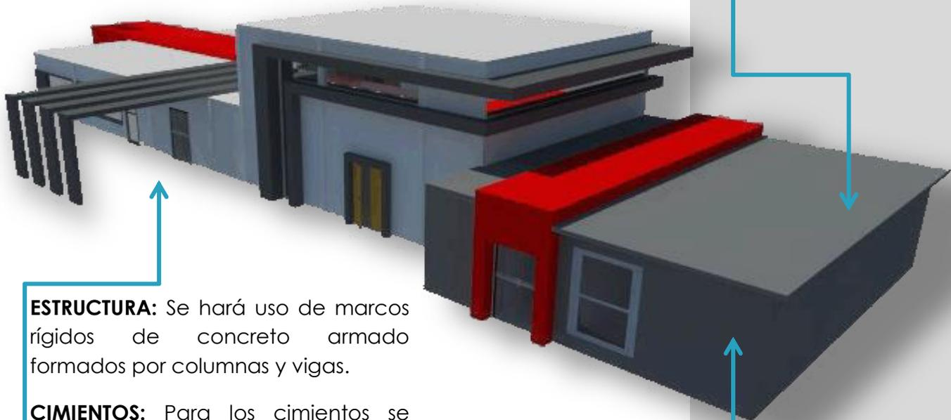
**ESTRUCTURA:** Se hará uso de marcos rígidos de concreto armado formados por columnas y vigas.
