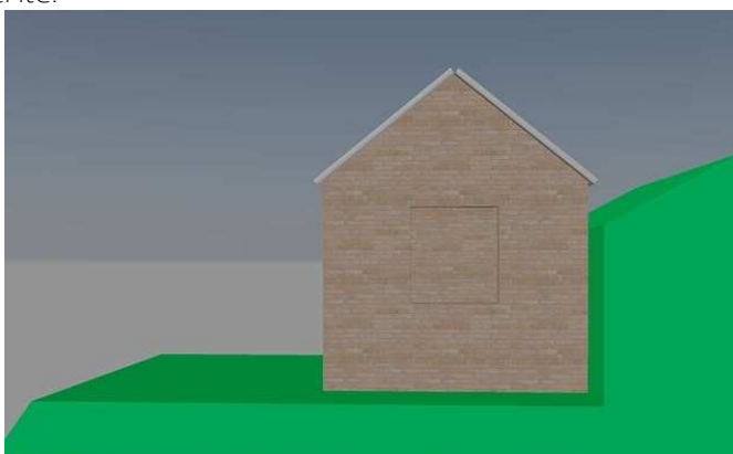
Figura 13. Vivienda en riesgo por impactos horizontales de tierra. Elaboración propia. Fuente: Gernot Minke. http://www.gernotminke.de/
