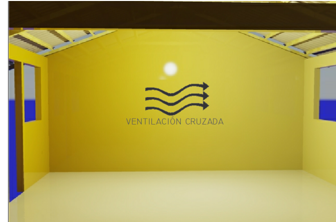
Figura 25. Ventilación cruzada. Elaboración propia.
