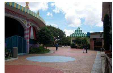
CIRCULACIÓN AMPLIA Y CON MATERIALES QUE PERMITEN FILTRACIÓN DE LAS AGUAS PLUVIALES HACIA MANTOS FREÁTICOS EN EL EXTERIOR DEL TEATRO
